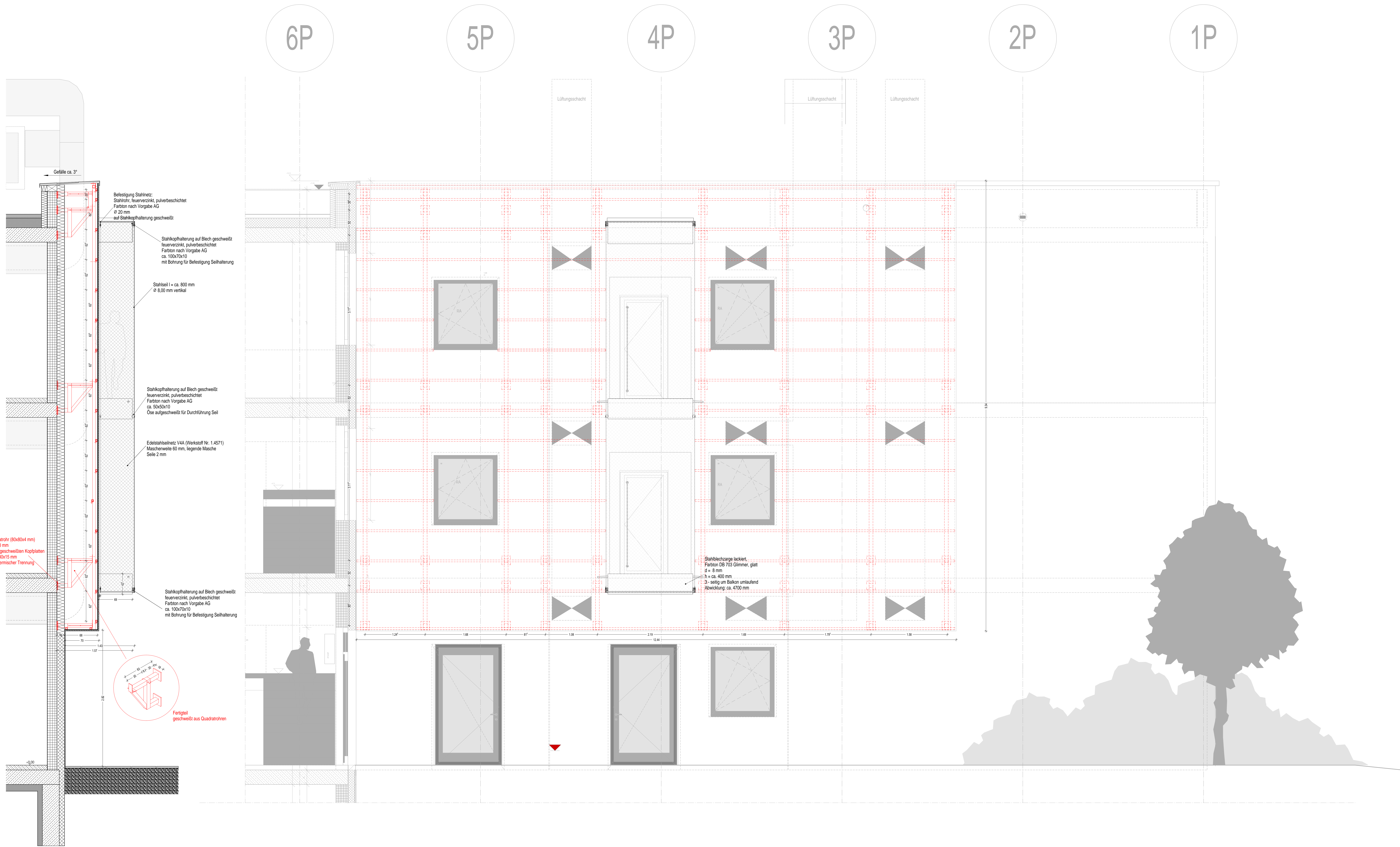
Vertikalschnitt Nordfassade Pflegebau
